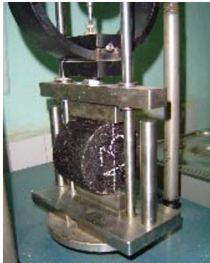
Hình 6.10. Thí nghiệm xác định cường độ ép chẻ
