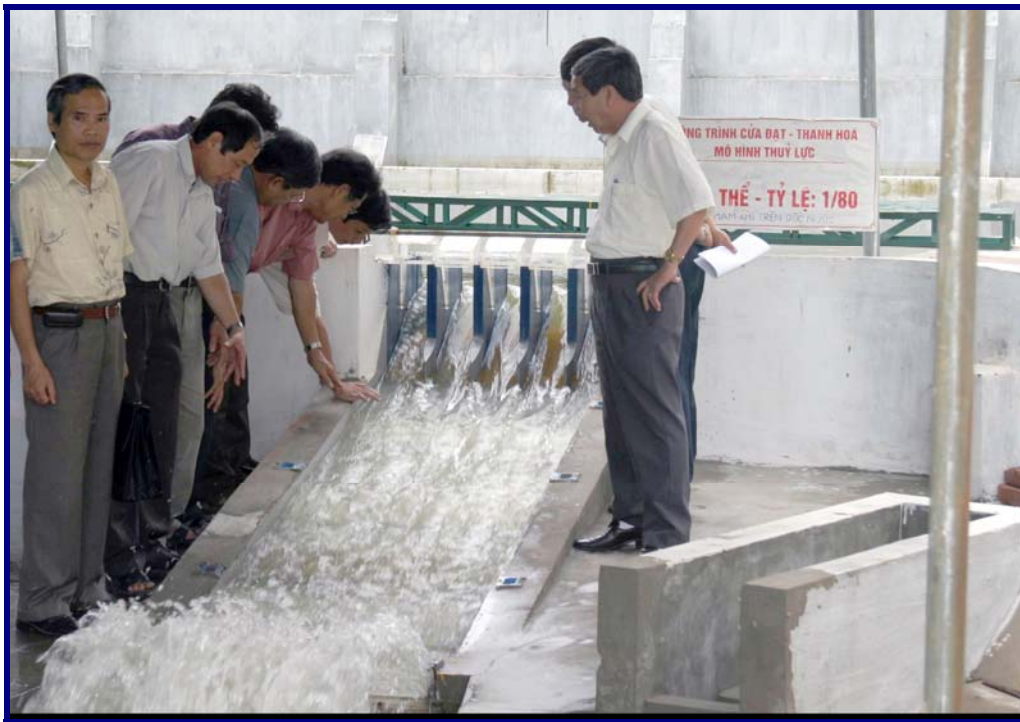
Ảnh 2.2. Mô hình tổng thể - dòng chảy trên dốc nước (có TBTK)
